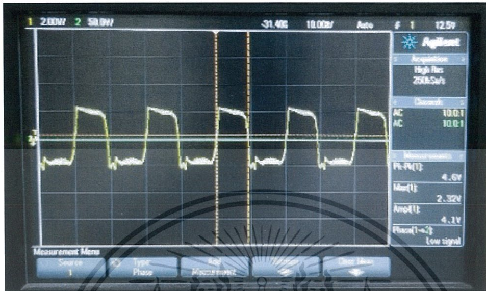
รูปที่ 4.2 สัญญาณขั้วขา gate ของ SCR
