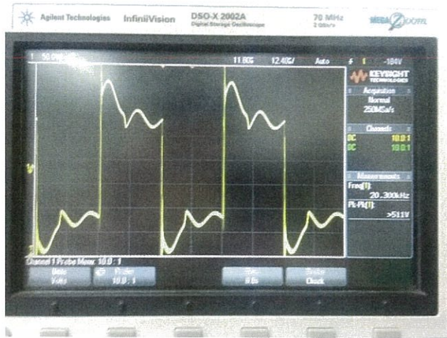
รูปที่ 4.3 สัญญาณที่ออกจากวงจร Full-Bridge converter
