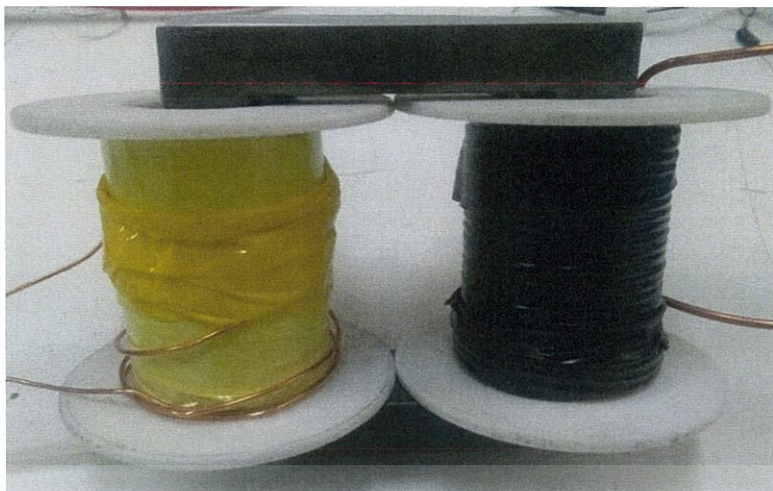
รูปที่ 3.19 Bobbin ที่ใส่ให้หม้อแปลงแล้ว
