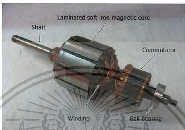
รูปที่ 2.8 โครงสร้างของโรเตอร์
