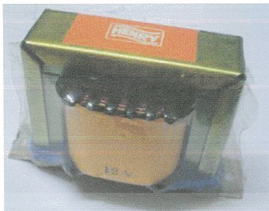
รูปที่ 2.4 หม้อแปลงชนิดแกนเหล็ก (Iron Core Transformer) [20]
