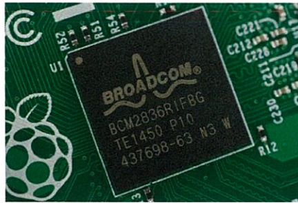
รูปที่ 2.11 ARM cortex-A7ส่วนประมวลผลของ Raspberry Pi 2
