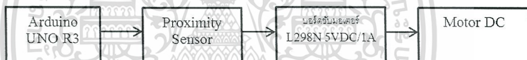
รูปที่ 3.7 แผนภาพชุดคำสั่งควบคุมการทำงานของระบบสายพานลำเลียง
