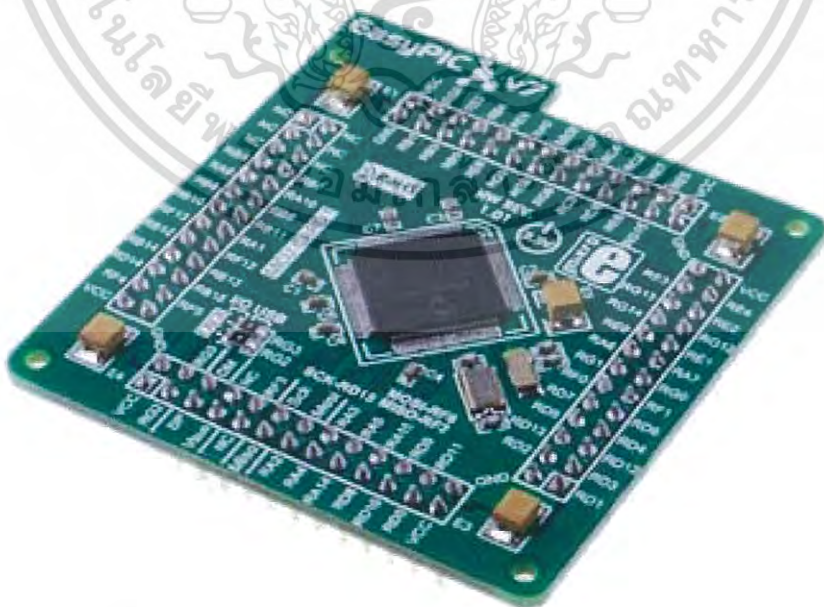
รูปที่ 3.15 ไมโครคอนโทรลเลอร์ dsPIC33ep512mu810
