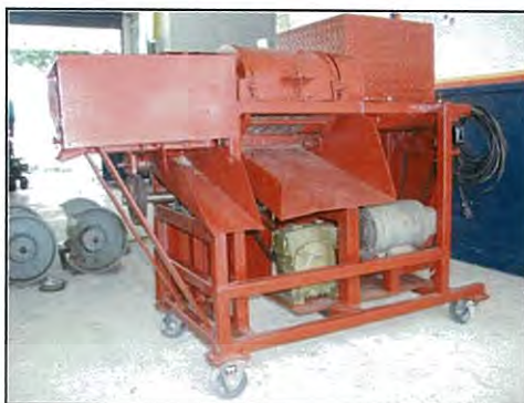
รูปที่ 2.41 เครื่องปอกเปลือกเหง้าสับประรด[27]
