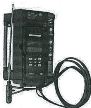
รูปที่ 5.10 เครื่องวัดแก๊สไอเสีย Testo รุ่น 350 XL
