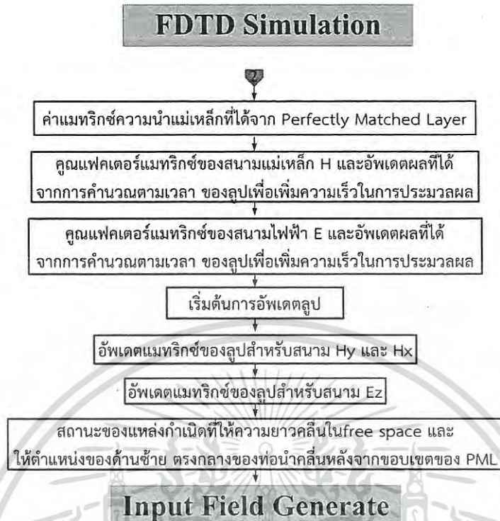
รูปที่ 3.6 โฟลว์ชาร์ตของ โปรแกรมย่อยเพื่อจำลองผลสนามไฟฟ้าและแม่เหล็กใน FDTD ด้วย MATLAB
