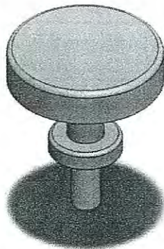
รูปที่ 3.5 อิเล็กโทรดแบบระนาบที่ใช้ในการจำลองการเกิดดิสชาร์จบางส่วน (ด้านแรงต่ำ)
