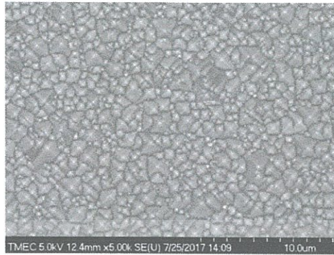
รูปที่ 4.10 พื้นผิวซิลิคอนหลังการกัดด้วยสารละลาย TMAH 5 wt% ที่เติมกรดซิลิสิก 34g/L ที่อุณหภูมิ 80 °C
