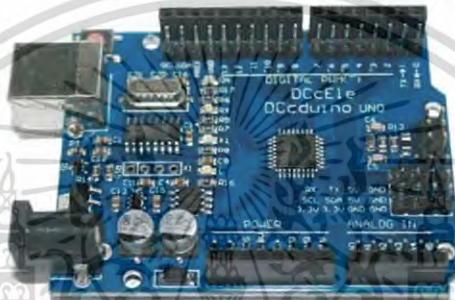
รูปที่ 2.11 Arduino Uno R3 แบบ SMD
