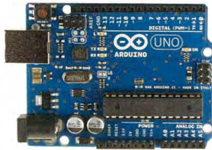
รูปที่ 3.15 ไมโครคอนโทรลเลอร์ Arduino Uno R3
