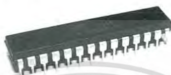
รูปที่ 2.9 ไมโครคอนโทรลเลอร์ Atmega328P-PU
