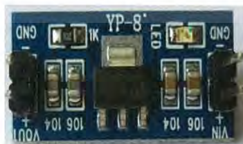
รูปที่ 2.8 โมดูลรักษาระดับแรงดันที่ใช้ไอซี AMS1117
