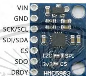
รูปที่ 3.13 โมดูลเซนเซอร์ตรวจจับแม่เหล็ก GY-282
