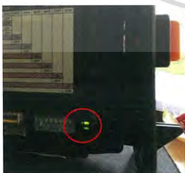
รูปที่ 4.3 เครื่องหยอดเหรียญแสดงสถานะไฟสีเขียวพร้อมใช้งาน
