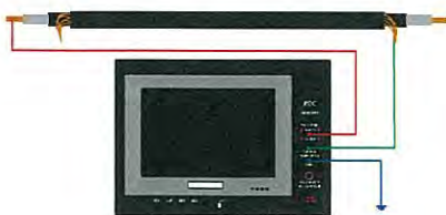
รูปที่ 4 แบบจำลองวงจรทดสอบ PDC แบบ isolated shield (วงจร 1)
