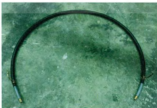
รูปที่ 3.17 สายเคเบิลฉนวน XLPE ยาว 3.5 m
