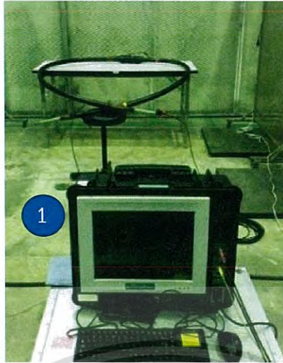
รูปที่ 3.2 วงจรวัดจริงที่ไม่ใช้อุปกรณ์จ่ายแรงดันเสริม(Phantom)
