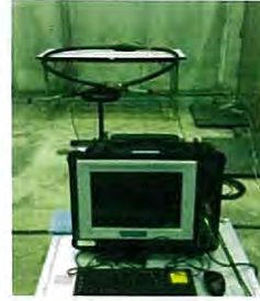
รูปที่ 5 วงจรทดสอบ PDC แบบ isolated shield (วงจร 1)
