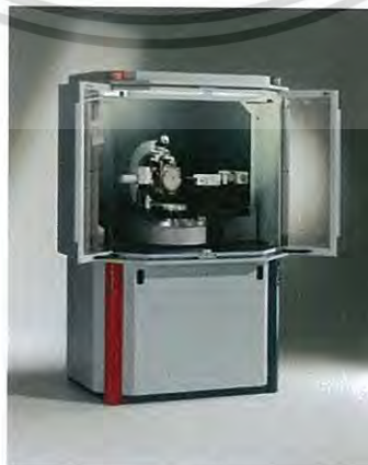
รูปที่ 3.5 เครื่องทดสอบการเลี้ยวเบนของรังสีเอ็กซ์ [27]
