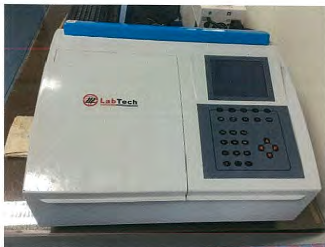
รูปที่ 3.8 เครื่องยูวี-วิสิเบิลสเปกโทรโฟโตมิเตอร์
