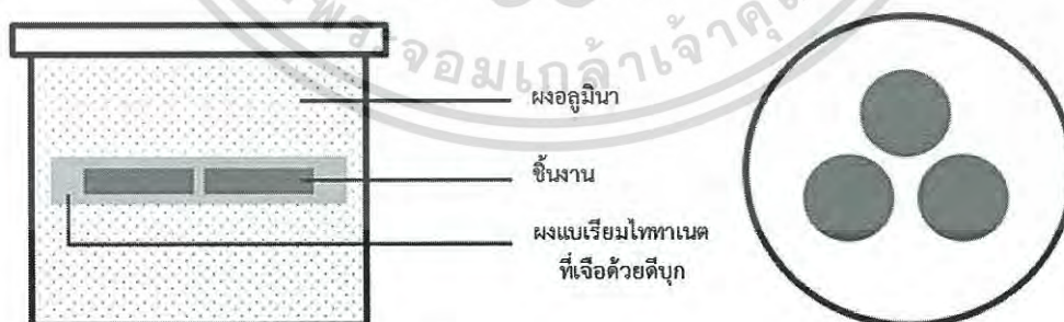
รูปที่ 3.2 การจัดเรียงชิ้นงานในถ้วยอลูมินาสำหรับเผาผนึก
