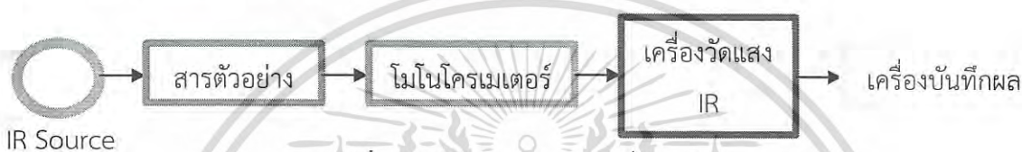
รูปที่ ก.1 ส่วนประกอบของเครื่อง FT-IR
