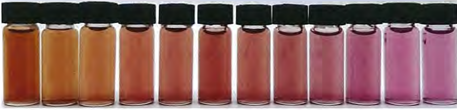
รูปที่ 2.1 ตัวอย่างเซนเซอร์ที่อาศัยการเปลี่ยนแปลงสีของสารละลาย
