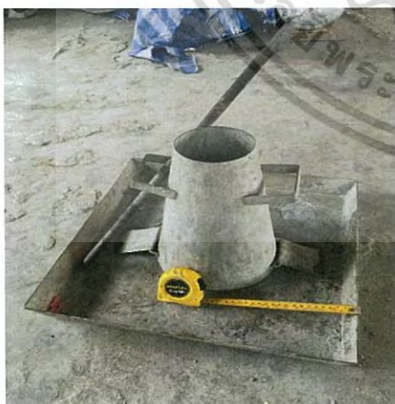
รูปที่ 3.10 อุปกรณ์เช็คค่าการยุบตัว(Slump tools)
