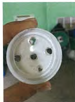
รูปที่ 3.7 ลักษณะฝาขวดที่เจาะรูโดยรอบ
