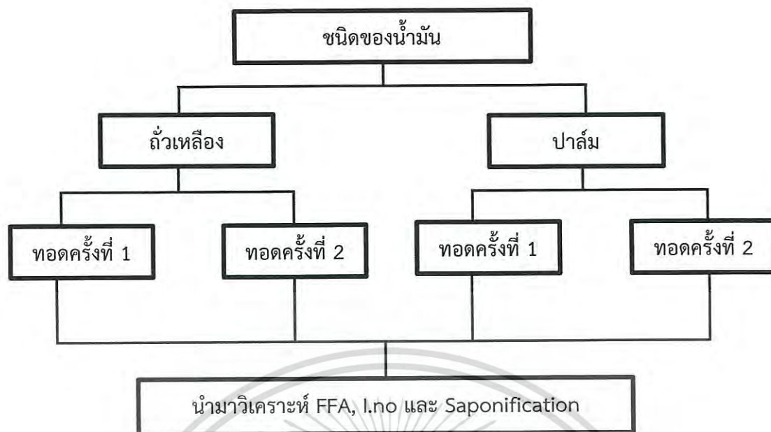
รูปที่ 3.9 แผนภาพการวิเคราะห์คุณสมบัติเบื้องต้นของน้ำมัน
