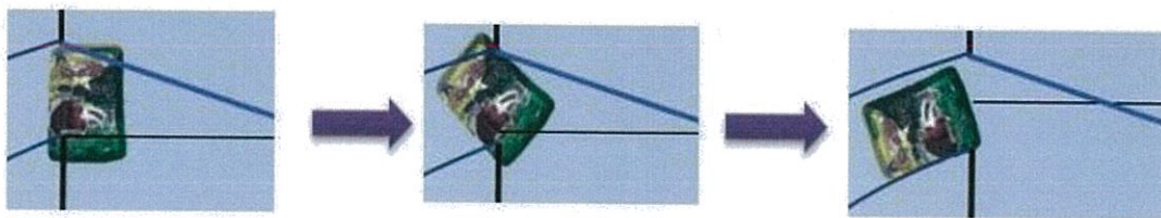
รูปที่ 3.13 ลักษณะการตกและพลิกกลับของถ้วยน้ำพริกแนวตั้งให้เป็นแนวนอน
