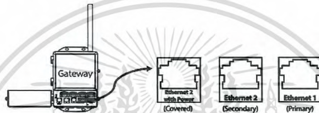
รูปที่ 2.18 แสดงจุดเชื่อมต่อ Ethernet ภายในสมาร์ทเกตเวย์แบบไร้สาย [23]
