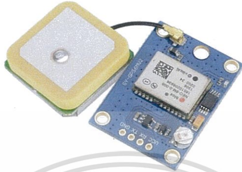
รูปที่ 2.3 GPS NEO-6M (ที่มา: https://bit.ly/2s18SKP )
