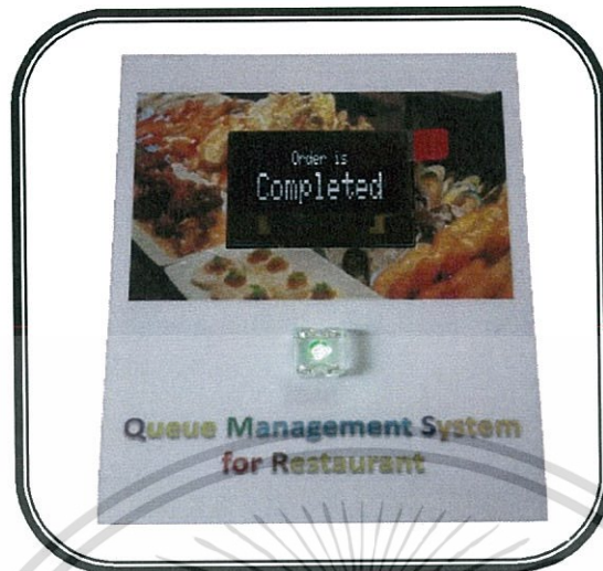
รูปที่ 4.13 เครื่องรับที่ได้รับสัญญาณตรงกับเครื่องส่ง
