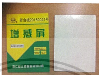
รูปที่3.3 ภาพแสดงแผ่นเรืองแสง (INTENSIFYING SCREEN)
