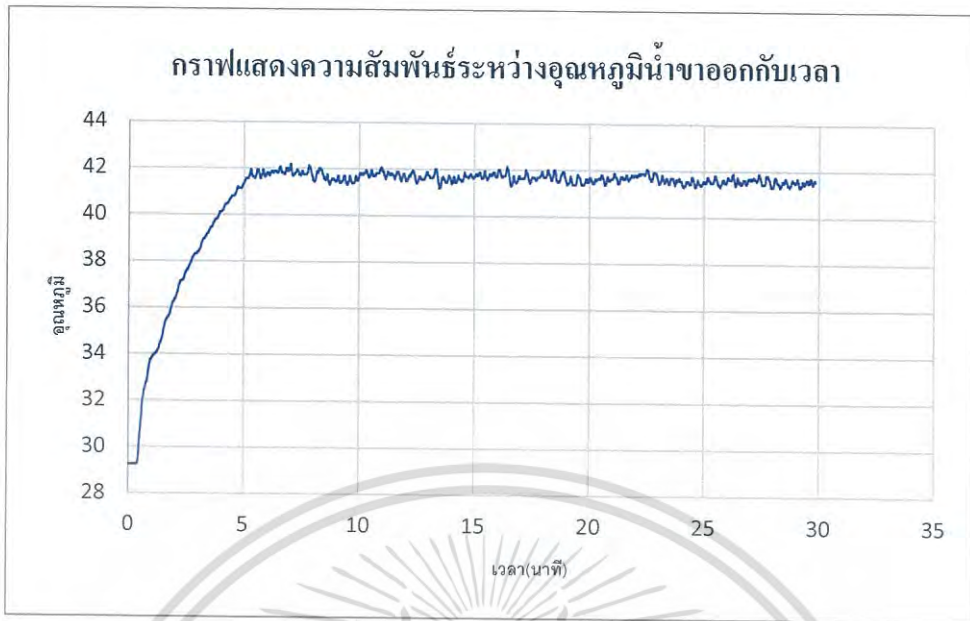
รูปที่ 4.11 กราฟแสดงความสัมพันธ์ระหว่างอุณหภูมิน้ำขาออกกับเวลาที่ 42 องศาเซลเซียส
