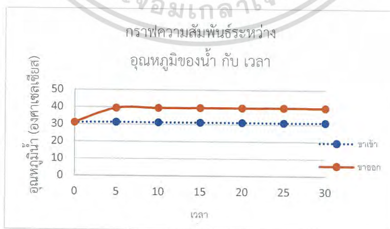
รูปที่ 4.6 กราฟความสัมพันธ์ระหว่างอุณหภูมิของน้ำกับเวลาที่อัตราการไหล 5 ลิตรต่อนาที
