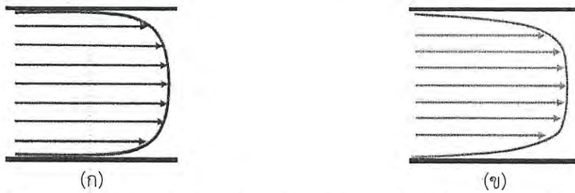
รูป 4.2 แนวเส้นความเร็วช่วงการไหลแบบปั่นป่วน (ก) ตัวเลขเรย์โนลด์สูง และ (ข) ตัวเลขเรย์โนลด์ต่ำ
