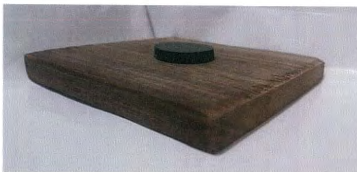
รูปที่ 3.8 แผ่นไม้และแผ่นยางที่ใช้ในการสอบเทียบ
