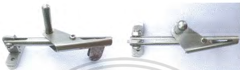
รูปที่ 4.7 ชุดกลไกจับด้ามไม้เสียบ
