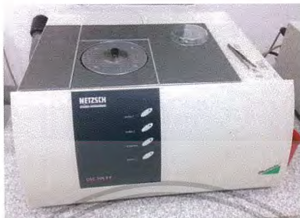
รูปที่ 3.4 เครื่องวิเคราะห์คุณสมบัติทางความร้อนเชิงพลังงาน
