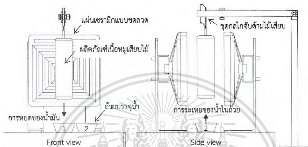
รูปที่ 3.7 การหาค่าการสูญเสียจากการหยดของน้ำมัน
