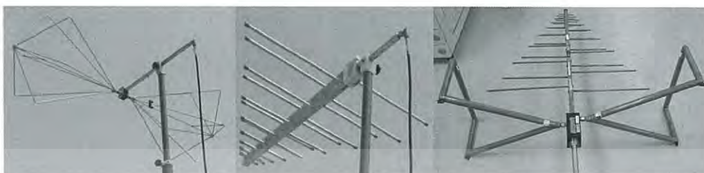
รูปที่ 2.27 สายอากาศที่ใช้ในการวัด โดยแสดงสายอากาศแบบ Bi-conical, Log-Periodic และ Bi-Log ตามลำดับ
