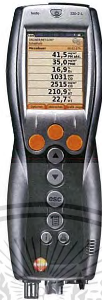
รูปที่ ข.1 เครื่องวัดประสิทธิภาพการเผาไหม้ของหม้อไอน้ำและเตาเผา รุ่น testo 330-2LL
