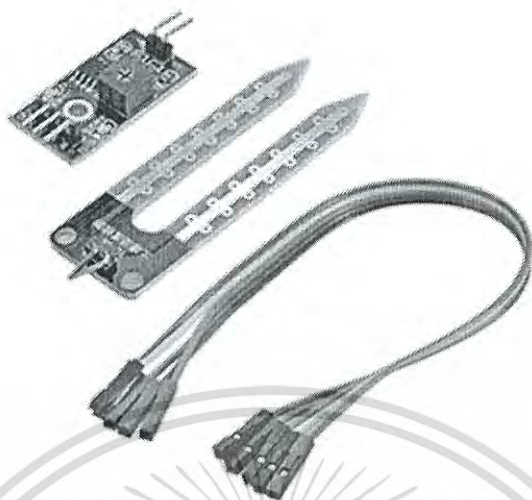
รูปที่ 2.5 เซนเซอร์วัดความชื้น (Soil moisture sensor)
