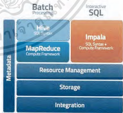
รูปที่ 11. แสดงการเปรียบเทียบการทำงานของ Hive และ Impala
