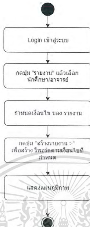
รูปที่ 3.9 แสดงแผนภาพกิจกรรม Use Case ของการดูรีพอร์ตแสดงแผนภูมิภาพ โดยสรุปตามที่ใช้กำหนดเงื่อนไขในระบบคลังข้อมูล
