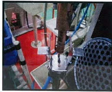
ลักษณะการวางชิ้นงานลงบน Guide Pin
