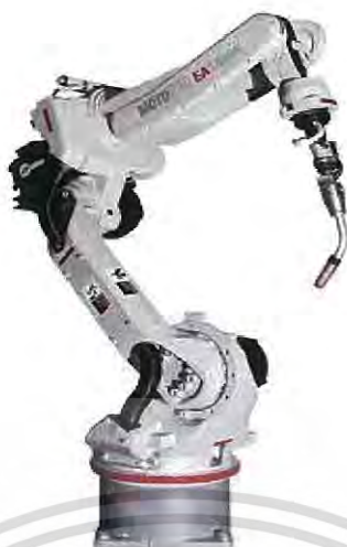
ภาพที่ 3.8 หุ่นยนต์การเชื่อมประกอบแบบแนวเชื่อม (Robot Welding)
