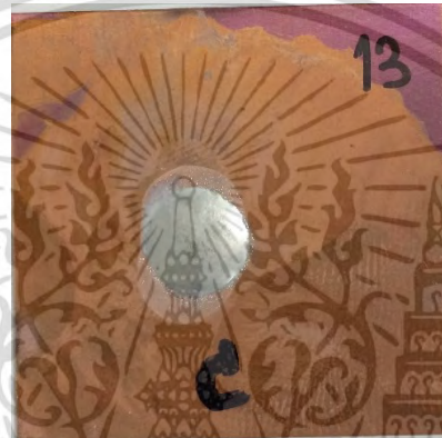
รูปที่ ง.13 การกระจายตัวของโลหะบัดกรี SAC305-1.0TiO 2
