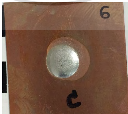
รูปที่ ง.6 การกระจายตัวของโลหะบัดกรี SAC305-0.05Mn-doped \text{TiO}_2 -0.5In
