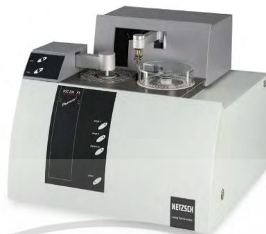
รูปที่ 3.8 เครื่อง DSC สำหรับทดสอบอุณหภูมิหลอมเหลว [48]
