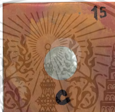
รูปที่ 15.15 การกระจายตัวของโลหะบัดกรี SAC305-0.1TiO 2 -0.5In
