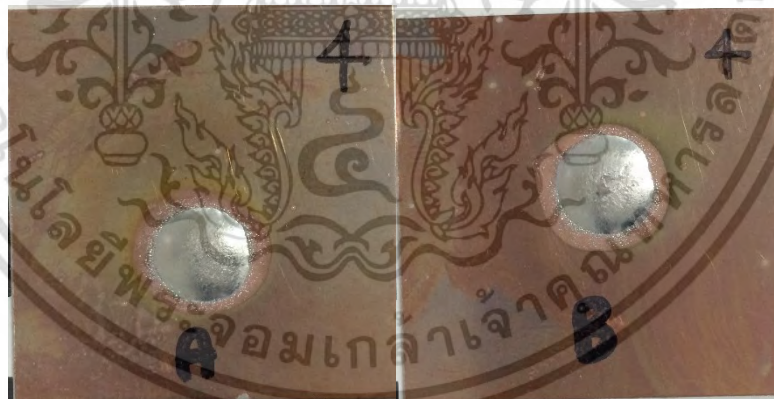
รูปที่ ๓.3 การกระจายตัวของโลหะบัดกรี SAC305-0.1Mn-doped \text{TiO}_2
