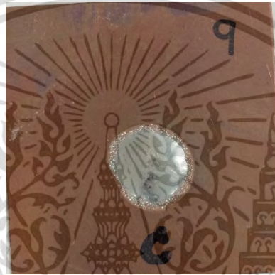
รูปที่ ๙.๙ การกระจายตัวของโลหะบัดกรี SAC305-1.0Mn-doped \text{TiO}_2 -0.5In
