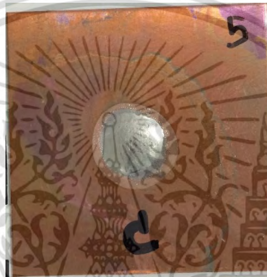
รูปที่ ง.5 การกระจายตัวของโลหะบัดกรี SAC305-1.0Mn-doped \text{TiO}_2
