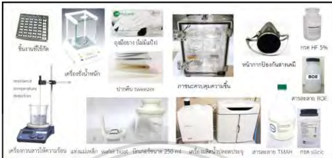
รูปที่ 3.4 อุปกรณ์ที่ใช้ในกระบวนการกัดเปียกแบบแอนไอโซทรอปิกของตัวตรวจวัดแสง จากศูนย์วิจัยอิเล็กทรอนิกส์ (ERC)
