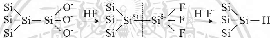
รูปที่ 3.6 การลอกชั้นออกไซด์ที่เกิดจากธรรมชาติ (native oxide) ด้วยกรดไฮโดรฟลูออริก
