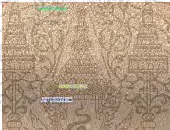
รูปที่ 4.8 พื้นผิวซิลิคอนหลังจากการกัดด้วยสารละลาย TMAH 5 wt% ที่เติมกรดซิลิซิก 34 g/l ที่อุณหภูมิ 80 องศาเซลเซียส ที่กำลังขยาย 1,500 เท่า
