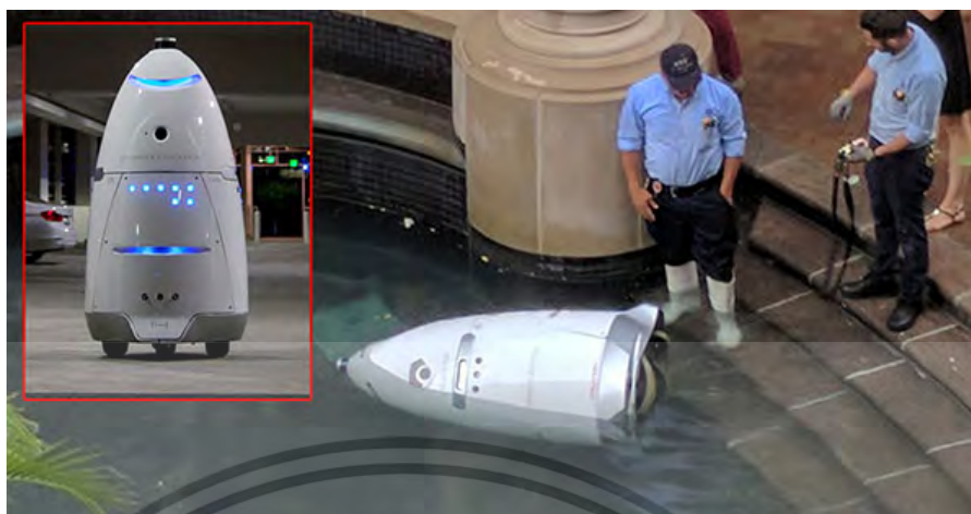
รูปที่ 1.2 อุบัติเหตุจากความผิดพลาดในการระบุตำแหน่ง
