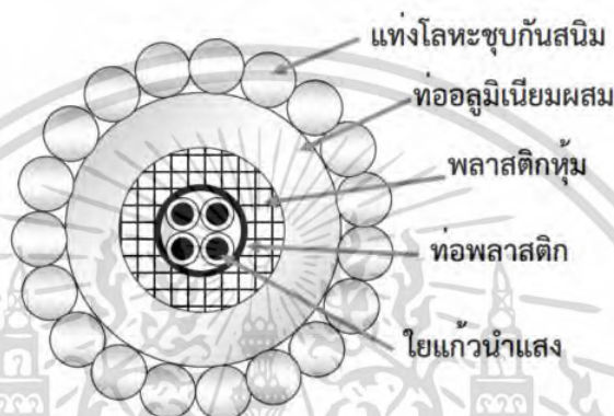
รูปที่ 3.27 โครงสร้างของสายเคเบิลใยแก้วนำแสง (Fiber-optic) [5]
