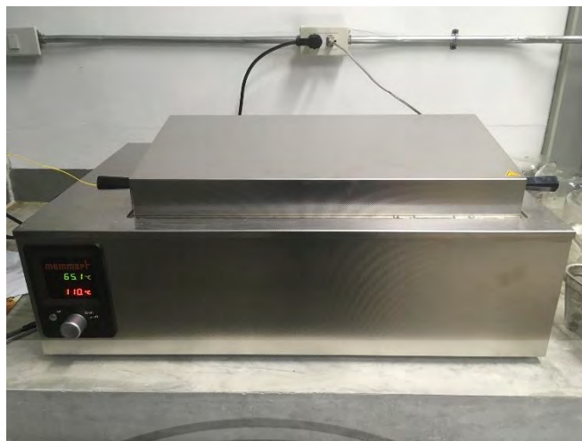
ภาพที่ 3.1 อ่างควบคุมอุณหภูมิ รุ่น WNB29, Memmert
