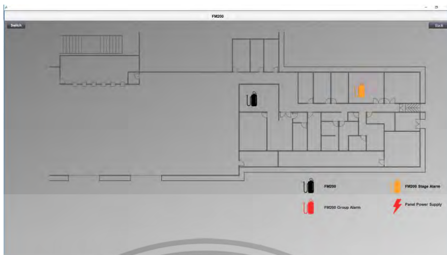
รูปที่ 4.89 แสดงสถานะ FM200 ภายในห้องเกิดการทำงานในขั้นแรก
