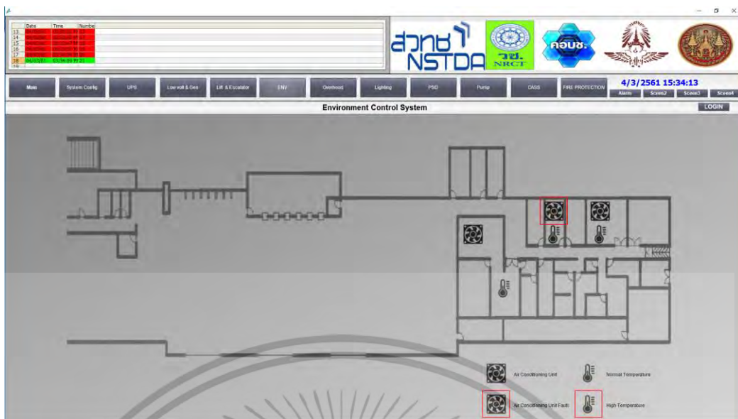
รูปที่ 4.102 การแสดงผลการทำงานของห้องกำเนิดไฟฟ้าที่มีระบบปรับอากาศชำรุด
