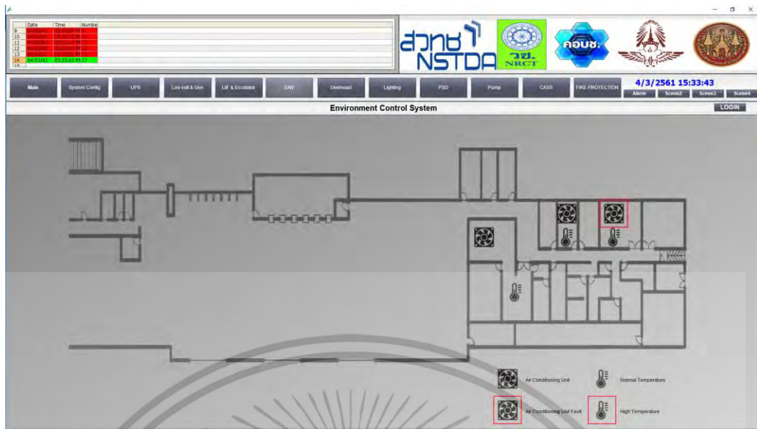
รูปที่ 4.100 การแสดงผลการทำงานของห้องสื่อสารที่มีระบบปรับอากาศชำรุด
