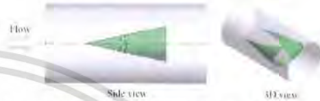
รูปที่ 3 กรวยวงรีดัดแปลงที่ \alpha=12.82^\circ
