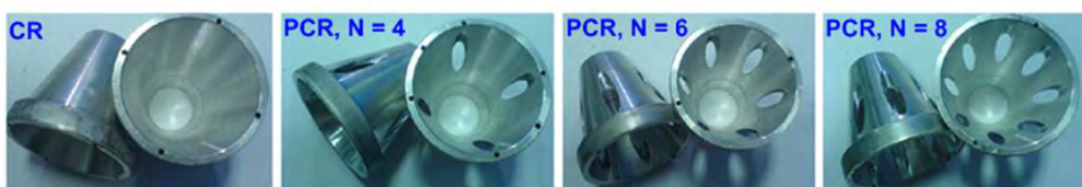
รูปที่ 2.6 แสดงลักษณะของแหวนทรงกรวยที่มีการเจาะรู [14]
