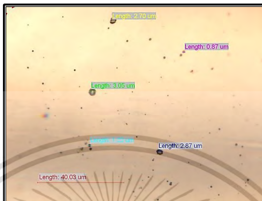
รูปที่ 4.2 ตัวอย่างลักษณะรูปทรงและการวัดขนาดของฐานพีระมิดที่ได้จากกล้องจุลทรรศน์แบบใช้แสง
