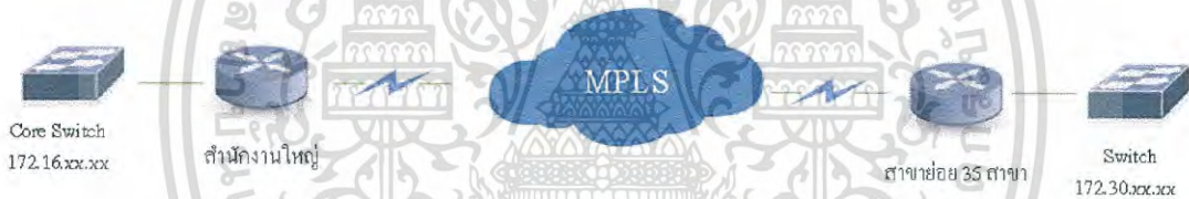
รูปที่ 3.1 โครงสร้างการเชื่อมต่อระบบเครือข่ายระหว่างสำนักงานใหญ่ และสาขาย่อย
