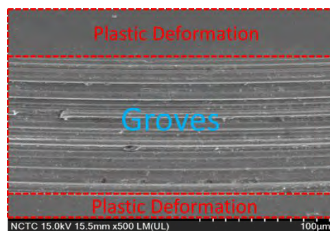
(b) น้ำมันหล่อลื่นผสมอนุภาค CB N220
