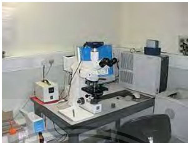
รูปที่ 3.5 กล้องจุลทรรศน์แบบแสง
