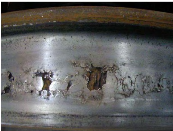
รูปที่ 3.10 การการแตกเป็นเศษเล็ก ๆ ของพื้นล้อ [14]
