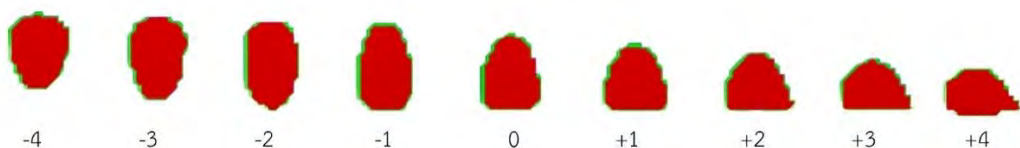
รูปที่ 5.18 พื้นที่สัมผัสที่ตำแหน่งต่าง ๆ ในกรณีที่รางรถไฟมีมุมเอียง 1/30
