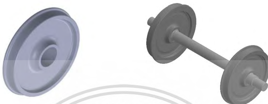
รูปที่ 3.2 ล้อ (ซ้าย) และชุดล้อพร้อมเพลลา (ขวา)
