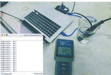
รูปที่ 20. การทดสอบอุปกรณ์ตรวจวัดค่าอุณหภูมิ
