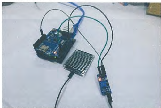
รูปที่ 14. การเชื่อมต่ออุปกรณ์ตรวจจับน้ำฝน
