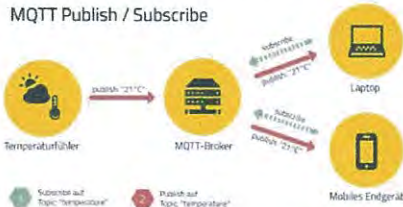
รูปที่ 1. หลักการทำงานของ โปรโตคอล MQTT
