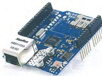
รูปที่ 3. วงจร Ethernet Shield รุ่น W5100
