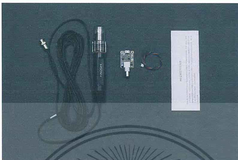
รูปที่ 2.6 เซ็นเซอร์วัดค่ากรด-ด่างแบบอนาล็อก (Analog pH Meter Pro)
