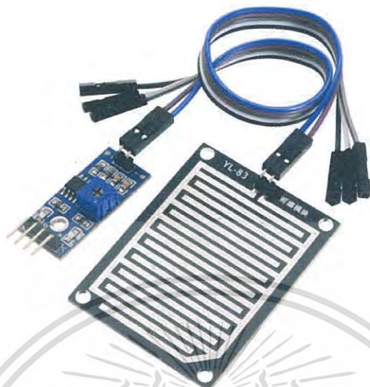
รูปที่ 2.9 เซ็นเซอร์วัดน้ำฝน (Rain / Water Detection Sensor) (ที่มาจาก http://www.campuscomponent.in/sensor.html )
