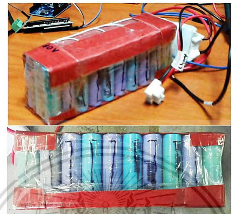
รูปที่ 4.3 แบตเตอรี่ชนิดลิเทียมไอออน ขนาด 36 volt, 20 Ah
