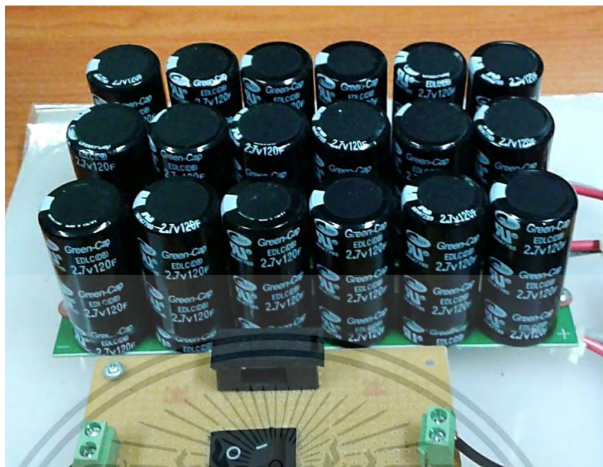
รูปที่ 4.4 ตัวเก็บประจุยิ่งยวด 2.7 V 120 F 18 ต่อแบบอนุกรม
