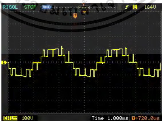
รูปที่ 4.33 รูปคลื่นแรงดันด้านออกของวงจรแปลงพื่นกำลังควบคุมด้วยสัญญาณแบบที่ 4 ที่ระดับแรงดันทดสอบ 20 kV
