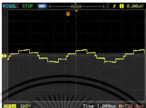
รูปที่ 4.12 รูปคลื่นแรงดันด้านออกของวงจรแปลงผันกำลังควบคุมด้วยสัญญาณแบบที่ 2 ที่ระดับแรงดันทดสอบ 10 kV
