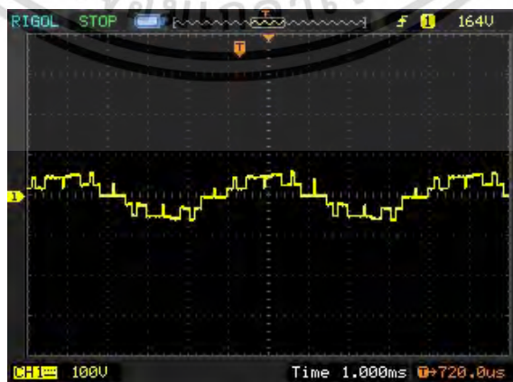
รูปที่ 4.30 รูปคลื่นแรงดันด้านออกของวงจรแปลงผันกำลังควบคุมด้วยสัญญาณแบบที่ 4 ที่ระดับแรงดันทดสอบ 10 kV
