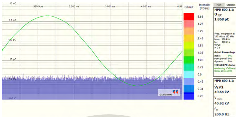
รูปที่ 4.29 ผลการทดสอบการตรวจจับการเกิดดิสชาร์จบางส่วนควบคุมด้วยสัญญาณแบบที่ 3 ที่ระดับแรงดันทดสอบ 40 kV
