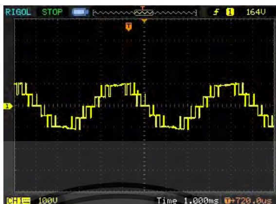
รูปที่ 4.42 รูปคลื่นแรงดันด้านออกของวงจรแปลงผันกำลังควบคุมด้วยสัญญาณแบบที่ 5 ที่ระดับแรงดันทดสอบ 20 kV
