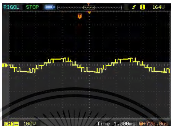
รูปที่ 4.39 รูปคลื่นแรงดันด้านออกของวงจรแปลงผันกำลังควบคุมด้วยสัญญาณแบบที่ 5 ที่ระดับแรงดันทดสอบ 10 kV
