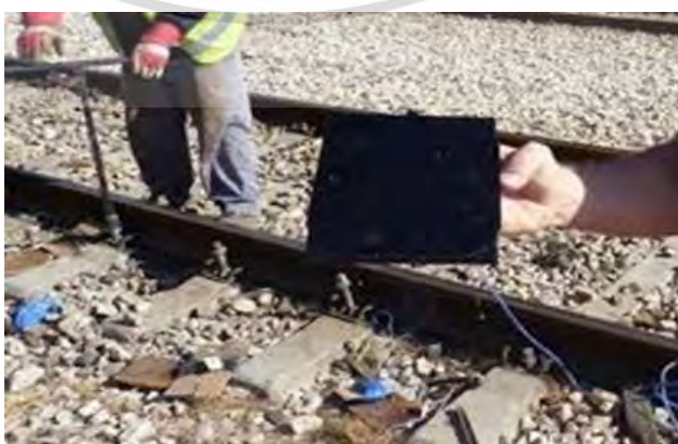
รูปที่ 1.6 แผ่นกำเนิดพลังงานติดตั้งที่ระบบรถไฟประเทศอิสราเอล
